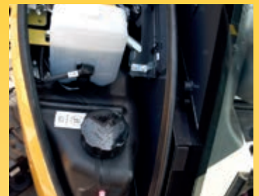
Rifornimento comodo e sicuro di olio e carburante sotto il cofano anteriore
