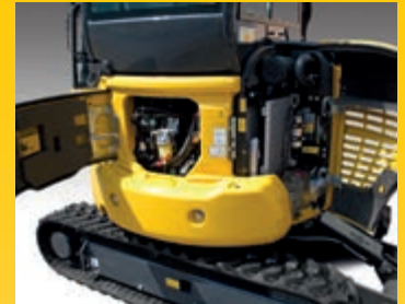
Cofani posteriori per controllo del motore, rifornimento carburante, ispezione e pulizia dei radiatori ed accesso alla batteria
