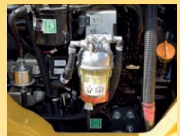
Grande filtro e prefiltro del carburante con separatore di acqua per proteggere il motore
